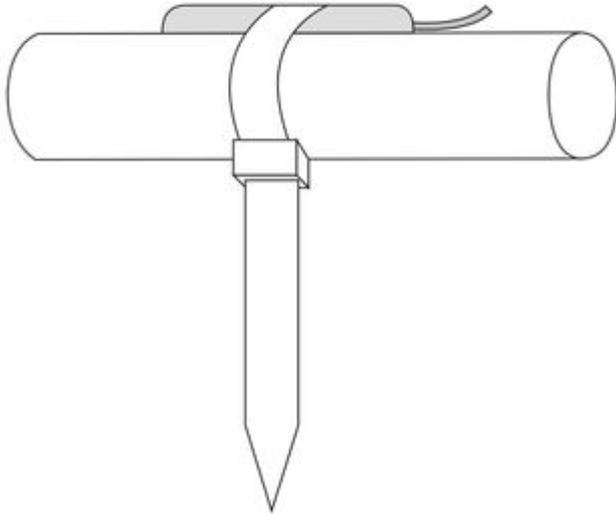
Проводной цифровой датчик температуры ZONT DS18B20 в металлической гильзе предназначен для измерения температуры теплоносителя системы отопления. Защищен от влаги. Не требует калибровки. Длина провода 1 м. Диапазон измеряемых температур: от -55 до +125 °С.
