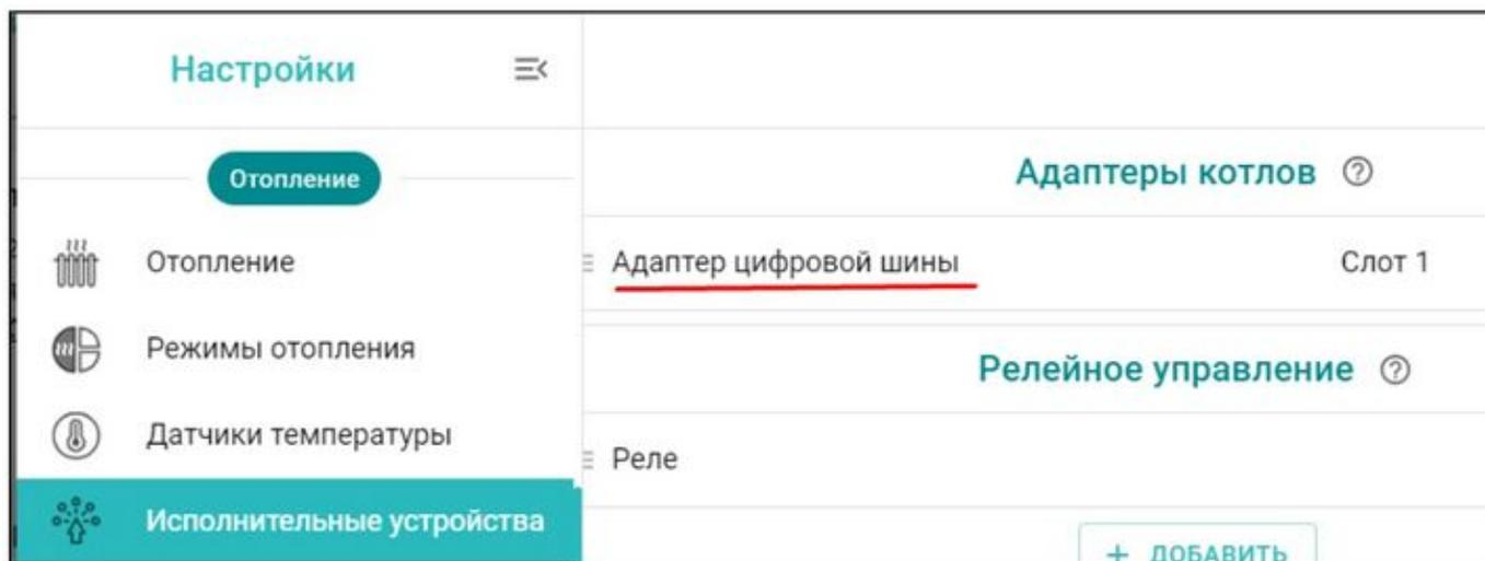
Проверьте и при необходимости укажите тип цифровой шины EMS+ и модель котла.
