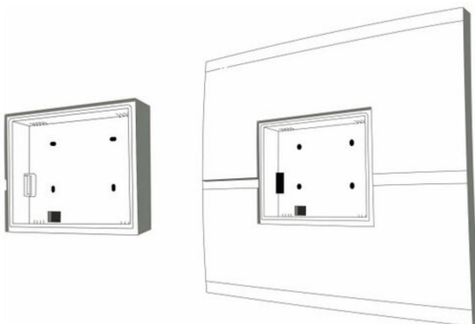
**2. Отожмите** защелки, расположенные по краям лицевой панели, и снимите переднюю панель основного блока Регулятора:
