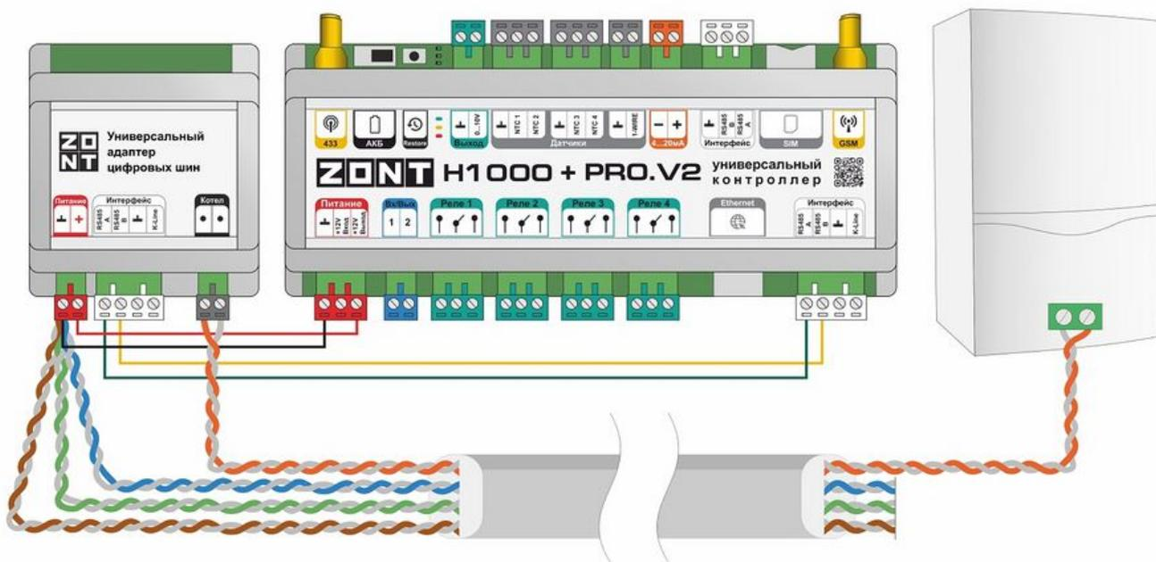
При исправном Адаптере и правильном подключении к прибору ZONT и цифровой шине котла индикаторы на корпусе адаптера периодически вспыхивают зеленым или красным цветом:
