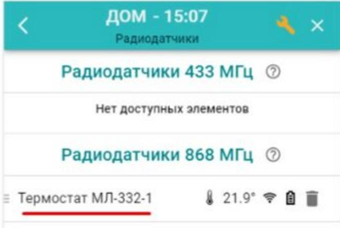
В конфигурации Контроллера ZONT Термостат применяется или как датчик температуры, по которому регулируется отопительный контур, или как источник данных для мониторинга температуры в месте его установки. Из личного кабинета сервиса ZONT пользователь может дистанционно изменить значение целевой температуры Термостата. Для этого необходимо в конфигурации Контроллера создать отдельный отопительный контур с комнатным термостатом МЛ-332 в качестве датчика температуры.
