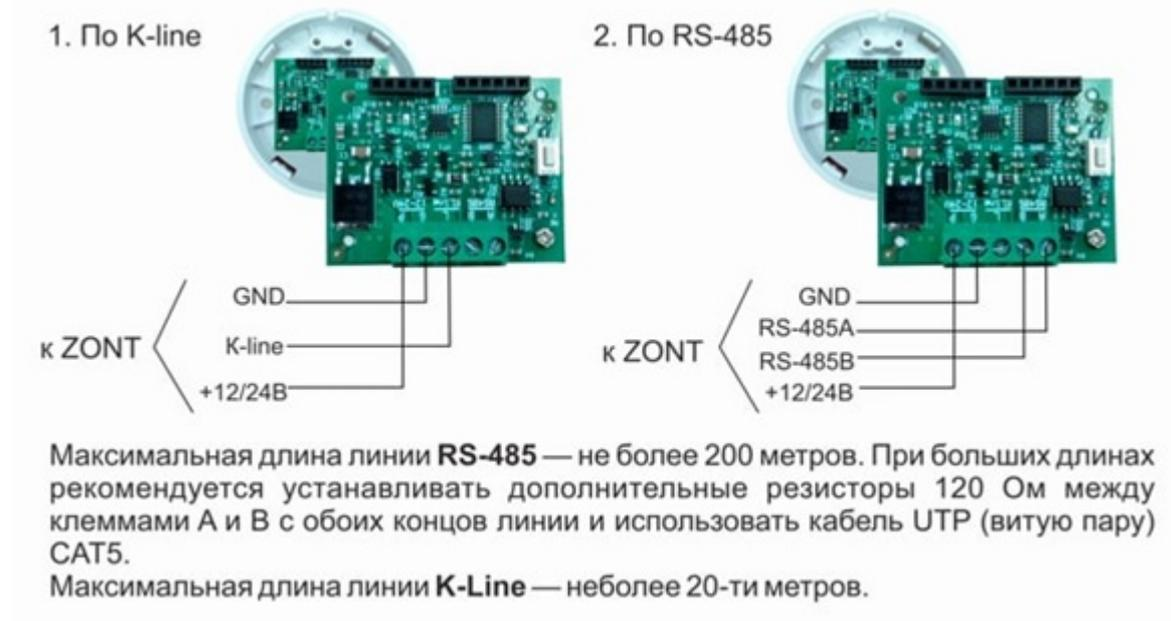
Максимальная длина линии [RS-485](#) не более 200 м. При больших длинах рекомендуется устанавливать дополнительные резисторы 120 Ом между клеммами А и В с обоих концов линии и использовать кабель UTP (витую пару) CAT5.
