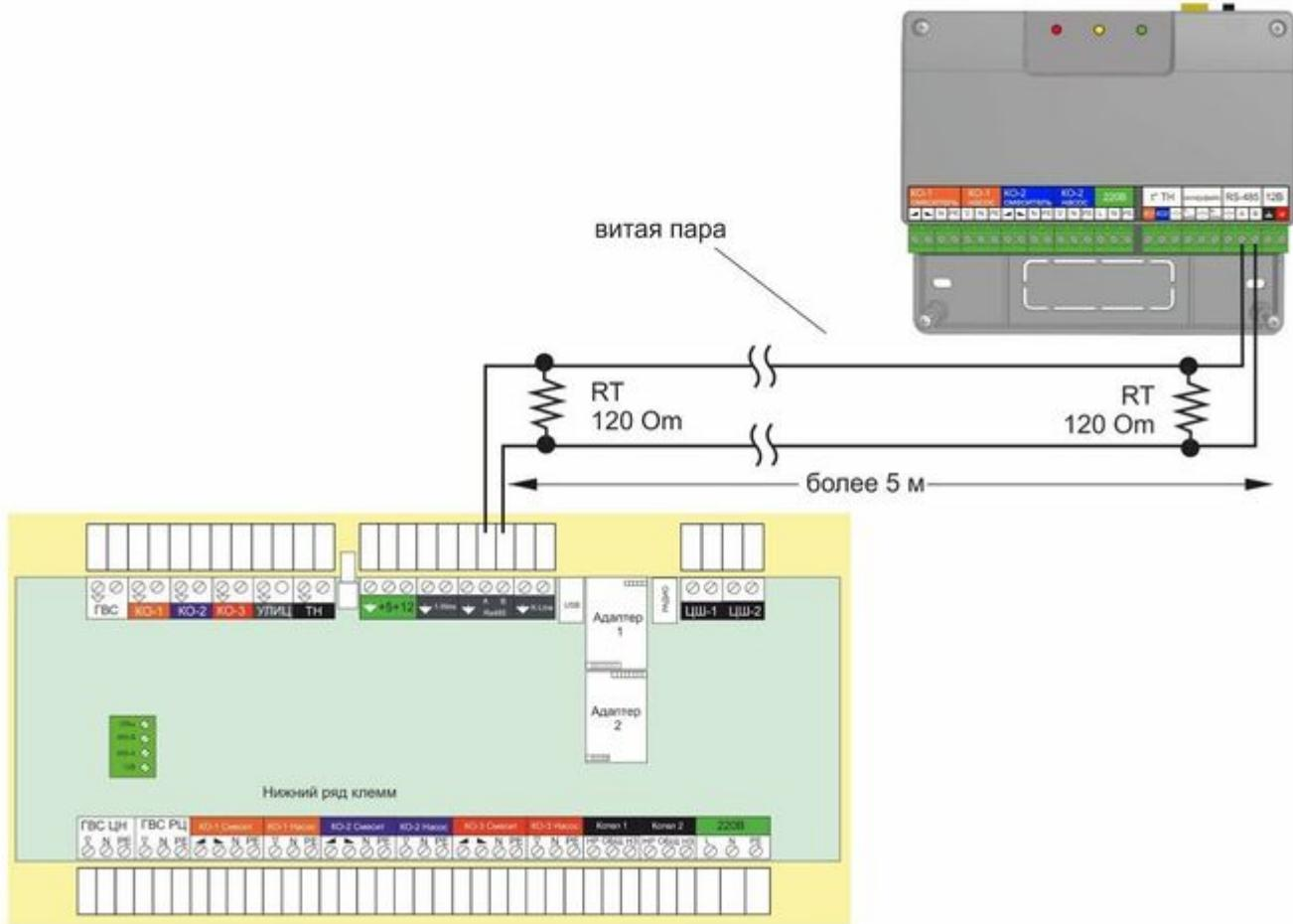
К Регулятору могут быть одновременно подключены 6 (шесть) БР. Схема последовательного подключения приведена ниже.
