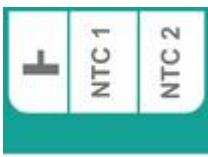
Клеммы для подключения аналоговых датчиков температуры NTC-10 или сторонних с теми же характеристиками. Клемма "минус" - общая для каждого датчика. Полярность не важна.
