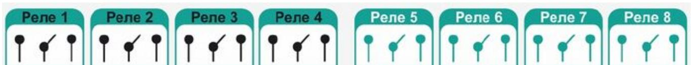
Релейные выходы БР в настройках основного контроллера имеют оригинальные номера с приставкой имени БР, указанному для него Пользователем на вкладке «Блоки Расширения».
