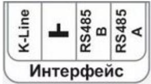
Клеммы подключения линии связи передачи данных по цифровым интерфейсам [RS-485](#) и [K-Line](#).
