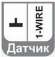
Клеммы для подключения шлейфа цифровых датчиков температуры [DS18S20 / DS18B20](#).
