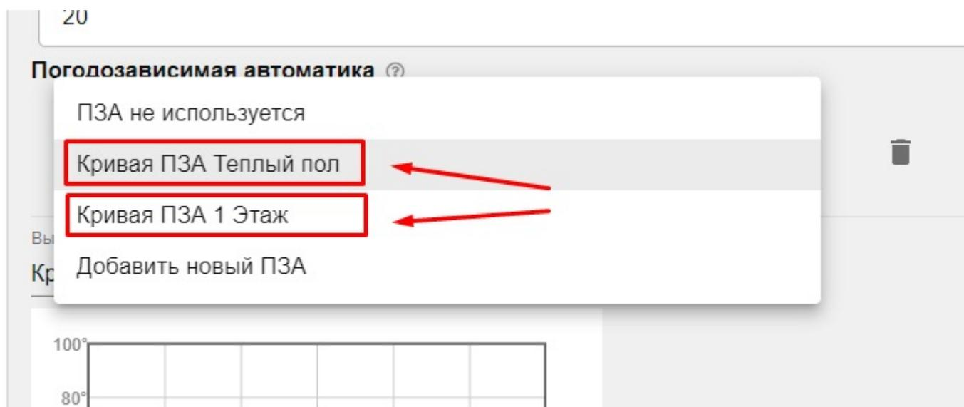
Затем при настройке контура используете именно его кривую. В этом случае редактирование одного контура не будет вызывать редактирование ПЗА в другом.
