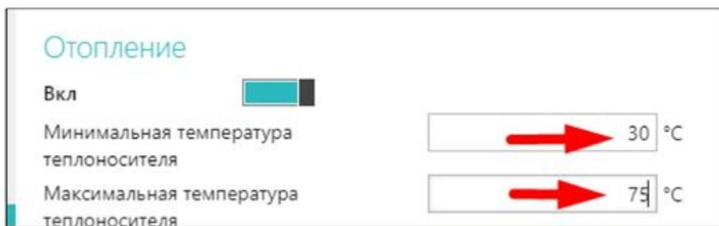
Гистерезис при управлении котлом в *Псевдорелейном режиме* применяется к температуре теплоносителя.
