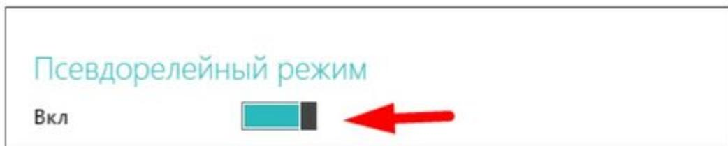
**ВНИМАНИЕ!!!** Котел при управлении в *Псевдорелейном режиме* нагревает теплоноситель до значения максимальной температуры, заданной настройкой "Цифровая шина - Отопление", и затем остывает до минимальной температуры, заданной этой же настройкой.
