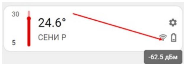
При плохом приеме нужно для радиодатчика найти оптимальное место размещения до того момента, как он будет закреплен на стене или потолке.
