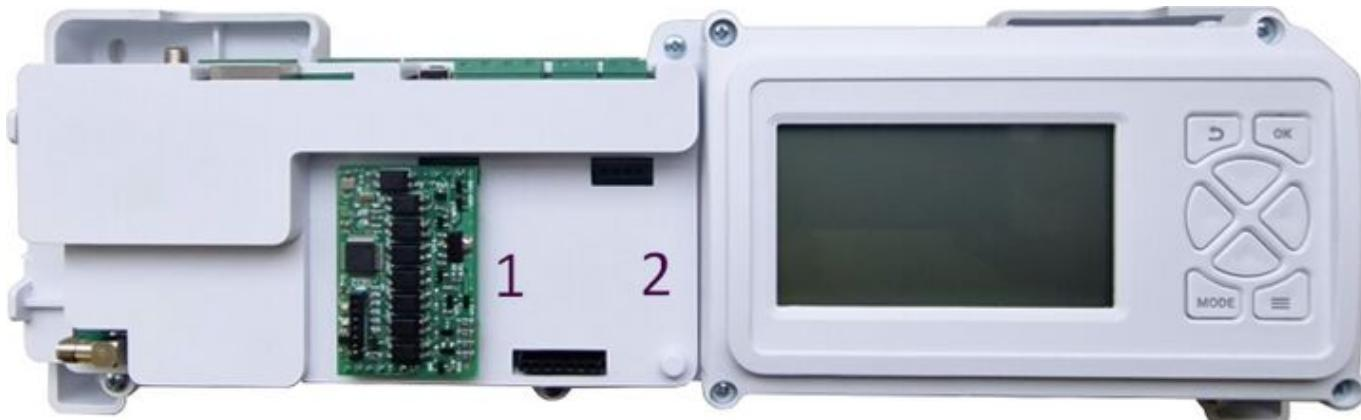
Порядок первого включения котла, управляемого основным Регулятором/Контроллером по цифровой шине, или повторного включения после внесения каких-либо изменений в его сервисные настройки, предусматривает следующую последовательность действий: сначала включается питание Котла и примерно через 3-5 минут – питание Регулятора/Контроллера.
