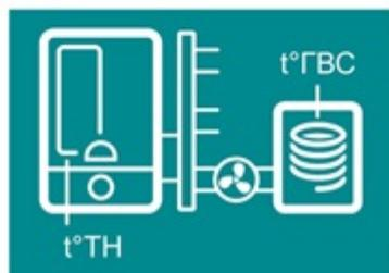
Первый вариант применяется, когда задача приготовления горячей воды выполняется котлом с проточным теплообменником или бойлером, подключенным к котлу. Котел управляется Контроллером по цифровой шине, а переключение режимов Отопления и ГВС осуществляет автоматика котла на основании сравнения целевой температуры, заданной Контроллером с фактическим значением горячей воды в контуре ГВС по данным от штатного датчика котла.
