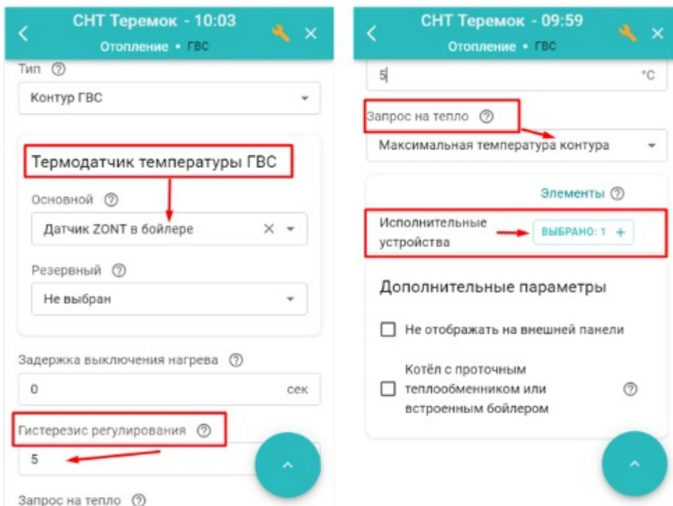
В конфигурации Контроллера задается отдельное исполнительное устройство "насос загрузки бойлера", а на вкладке Отопление задаются параметры работы контура - "Запрос на тепло",
