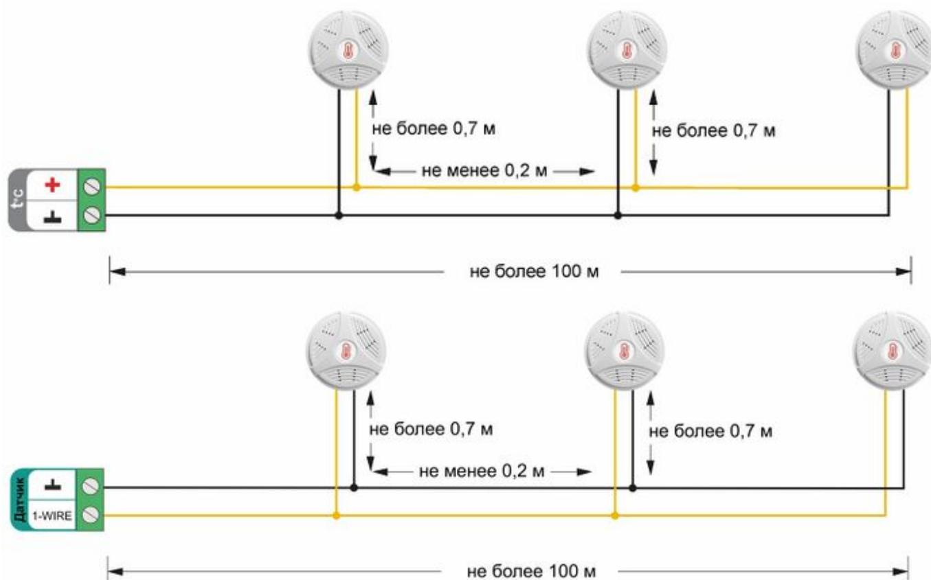
Подключение датчиков по трехпроводной схеме:
