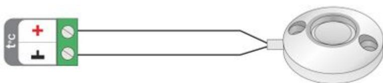
В том случае если необходимо подключить индикатор считывателя используется приведенная ниже схема. Ограничивающий резистор 1 кОм устанавливается в том случае, если считыватель не имеет встроенного ограничивающего резистора (необходимо уточнить в документации на считыватель).
